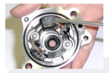
INSTALL NEW BRUSH TERMINAL INSIDE PLACE LITTLE RUBBER CAP ON THE TERMINAL.
